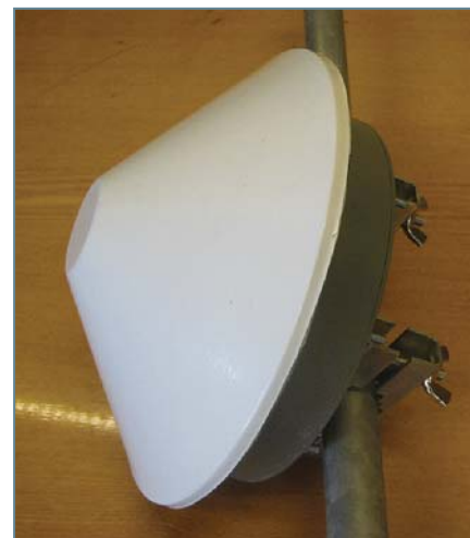
Р и с . 10. Планарная отражательная антенна, расположенная в радиопрозрачном корпусе
