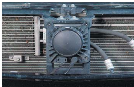
Рис. 3. Радарный датчик системы адаптивного круиз-контроля на модели Mercedes-Benz CL600 установлен прямо под эмблемой Mercedes в центре радиатора под капотом
