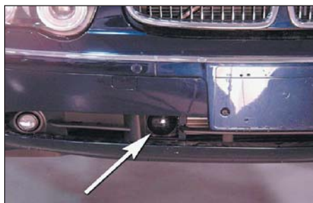
Рис. 2. Радарный датчик и модуль управления в модели BMW 745i расположен с обратной стороны переднего бампера. Радар виден через отверстие в бампере
