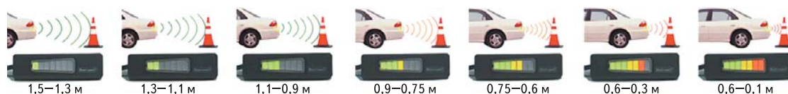
Рис. 4. Принцип работы системы радарной парковки
