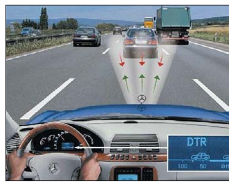
Рис. 1. Сигнал радара на системе круиз-контроля достаточно узок и предназначен только для того, чтобы следить за полосой движения, по которой движется автомобиль
