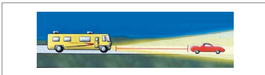
Рис. 7. Система Smart Cruise автоматически поддерживает безопасное расстояние между машинами
